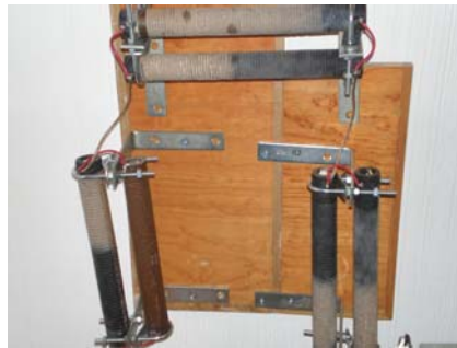
Fig. 44 Resistencia de disipación para el frenado regenerativo
