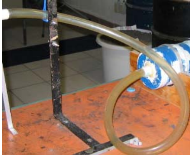
Fotografía 5.- Manguera flexible conectada al tubo horizontal
