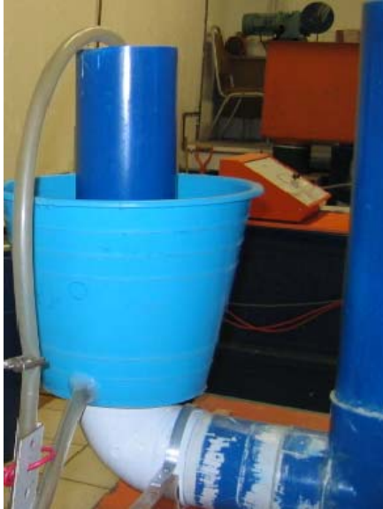
Fotografía 2.- Vertedor de cresta circular (borde del tubo azul oscuro).
