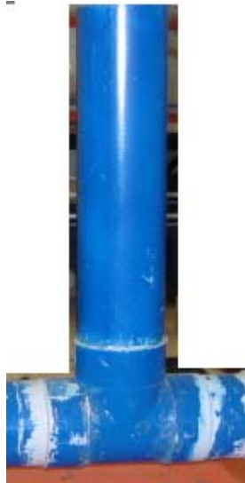
Fotografía 4.- Tubo de Regulación o Dispositivo de Regulación.
