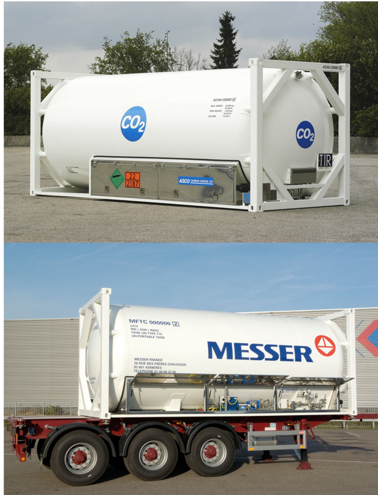
Figura 5.2 Tanque contenedor ISO 20' y Tanque contenedor ISO 20' en Tráiler de 3 ejes con capacidad para 20,000 lt y una P_{m\acute{a}x} = 22.43 \text{ km/cm}^2
