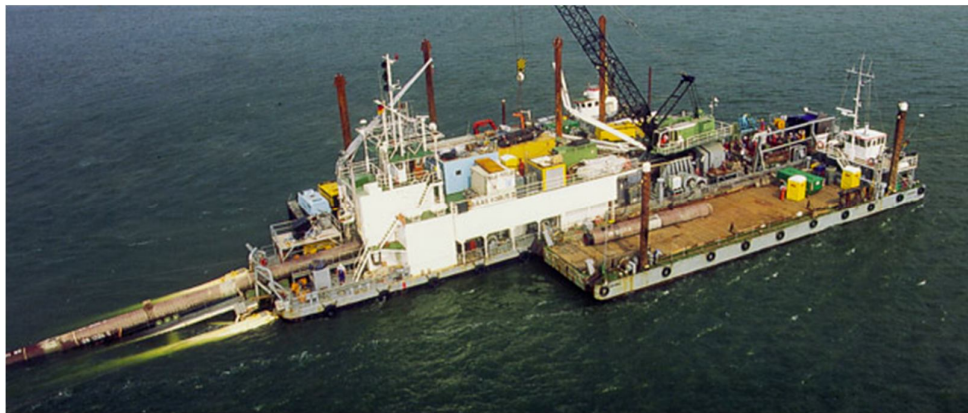
Figura. 3.15 Barcaza tendedora BAAS KOBUS III para aguas poco profundas
