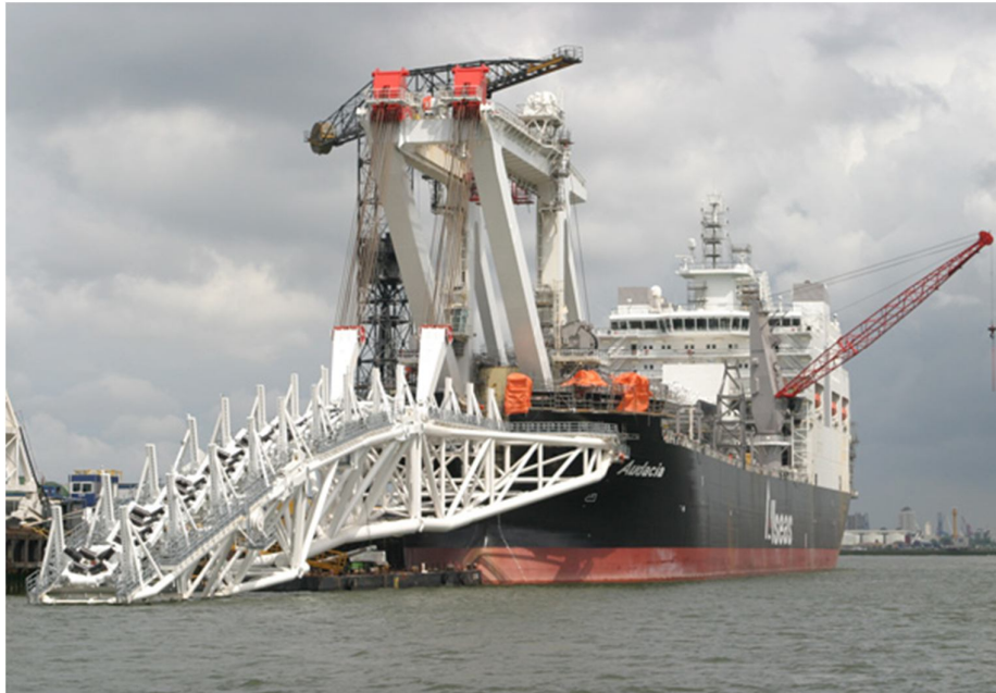
Fig. 3.13 Barcaza tendedora de tubería en lecho marino.
