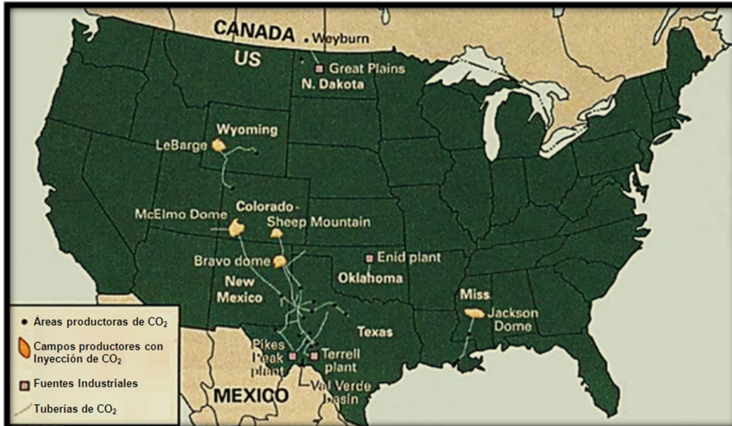
Figura. 3.5 Tuberías de CO 2 en América del Norte. (Cortesía de Oil and Gas Journal).
