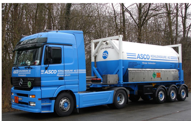
Figura 2.1 Tanque contenedor ISO 20', de 20,000 lt, de la compañía ASCO, carga útil (kg) CO 2 : 19'600 (370,518 scf aprox)
