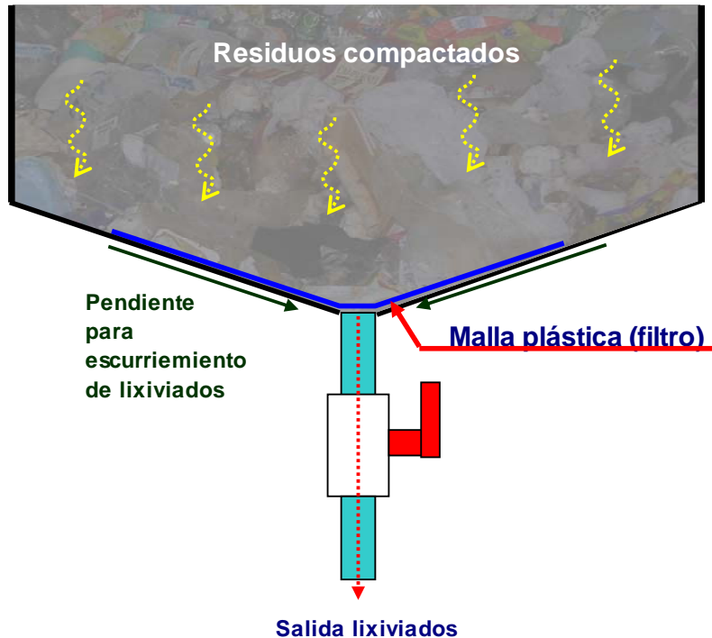
Figura 3.2. Sistema de drenaje de lixiviados
