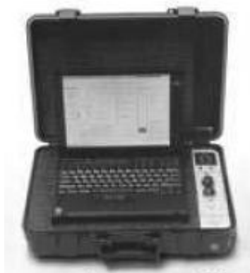
FIGURA 2.18 ANALIZADOR (WELL ANALYZER)
