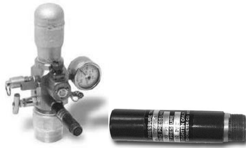
FIGURA 2.14 PISTOLA DE DISPARO REMOTO Y TRANSDUCTOR DE PRESIÓN
