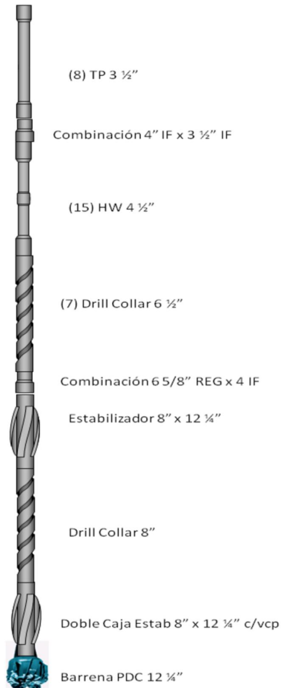
Figura 41. Diagrama esquemático de la sarta de perforación utilizada para la perforación de la etapa de 12 1/4" del pozo Escorpión-34.
