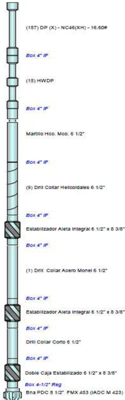
Figura 21. Diagrama esquemático de sartas de perforación programadas, etapa de 8 1/2\", pozos Escorpión-101 y Escorpión-9.
