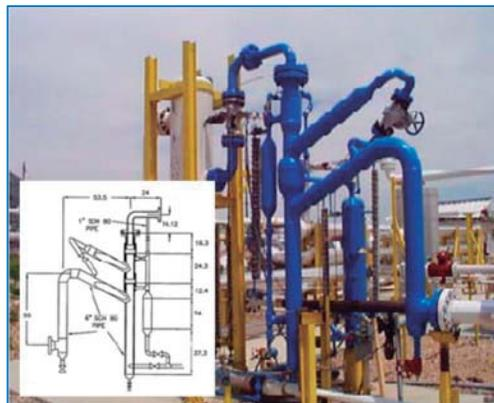
Figura 4.4 Estación CEESI para prueba en campos de gas húmedo (Kouba, et al., 2006).
