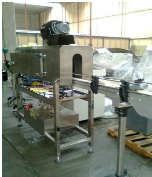
Foto 1. Horno a base de vapor de agua.
