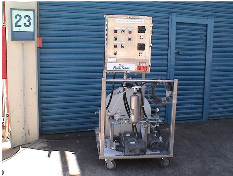
Figura 3.2. Planta piloto para dosificación del aditivo
