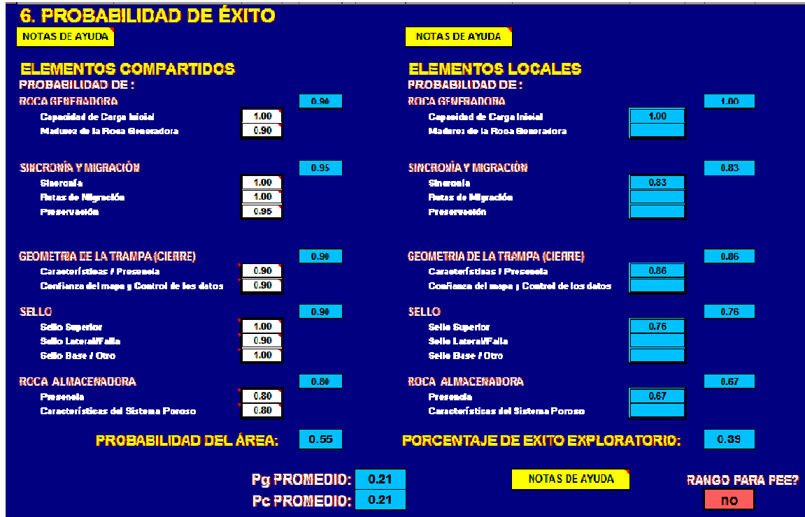
Figura 4.38. Resultados de la simulación Montecarlo realizada con la hoja de cálculo CERPlay (© PEMEX), para la probabilidad de éxito del play y de los elementos locales dentro del play. Para la evaluación monetaria se considera una tasa de cambio de 11.2 pesos mexicanos por cada dólar, y un VPN/Barril=19.33.
