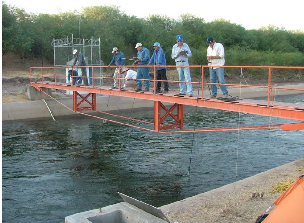
Foto 4- 2: Aforadores midiendo la velocidad con molinetes durante una prueba
