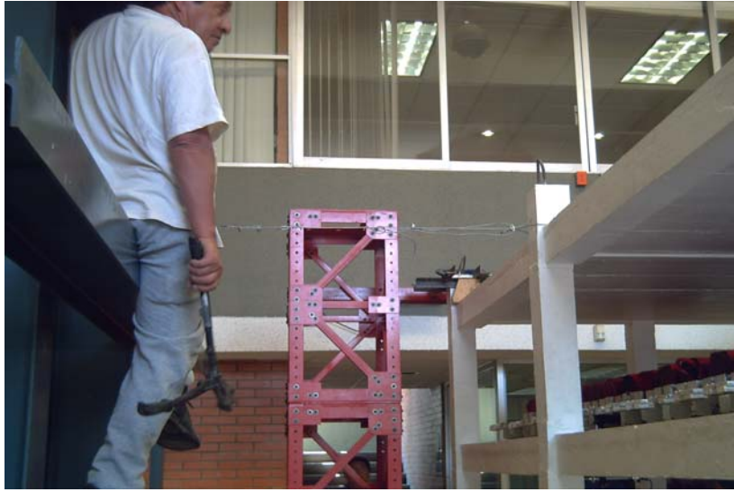
Fig. 3.39. Vista de la aplicación de la fuerza horizontal sobre el espécimen
