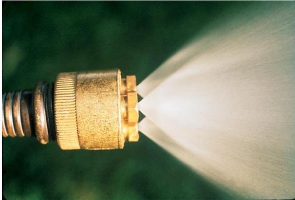
Imagen 4.1 Chiflón para humedecer y enfriar los agregados
