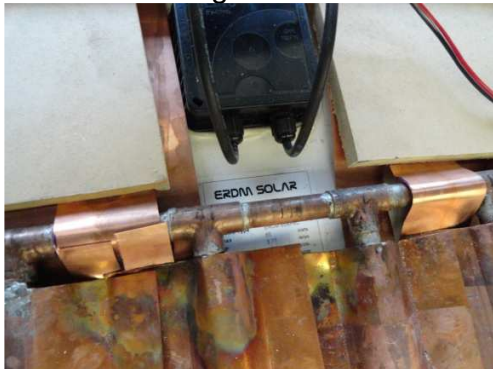
Gráfico A.3.11 Zona de contacto para el termómetro digital LM35
