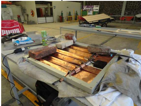
Gráfico A.3.9 Secado de la plastilina epóxica
