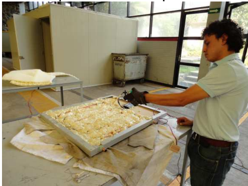
Gráfico A.3.15 Finalización de aplicación de espuma
