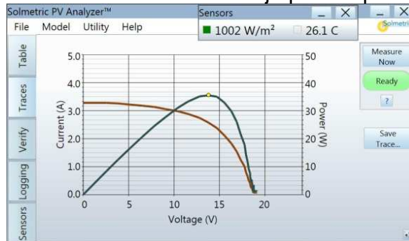
Gráfico 4.10 Curva corriente-voltaje para el panel híbrido
