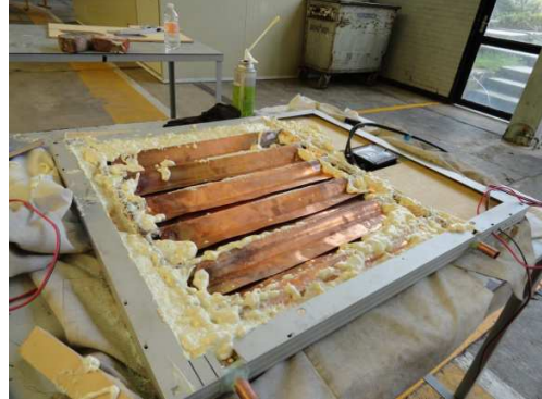
Gráfico A.3.14 Aplicación de la espuma de poliuretano
