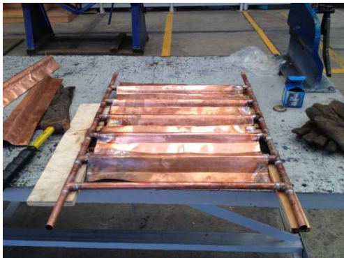
Gráfico A.3.5 Corte y doblado de las láminas de cobre
