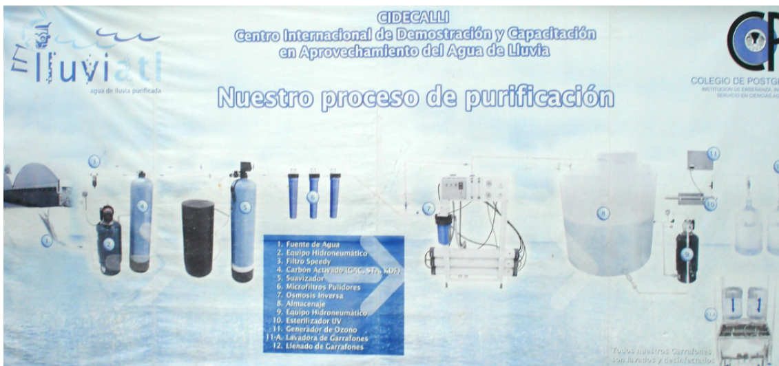
Figura 26. Proceso de purificación del CIDECALLI – 1. Fuente de agua, 2. Equipo hidroneumático, 3. Filtro speedy, 4. Carbón activado, 5. Suavizador o salmuera, 6. Microfiltros pulidores, 7. Osmosis inversa, 8. Almacenamiento, 9. Equipo hidroneumático, 10. Esterilizador UV, 11. Generador de ozono, 12. Lavadores de garrafonas, 13. Llenador de garrafonas.
