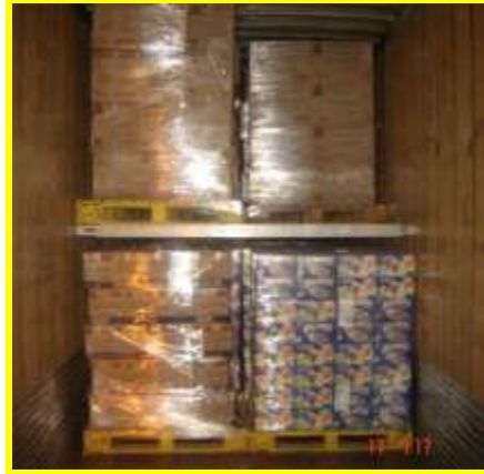
Fig. 6 Ejemplo de barra Crosby
