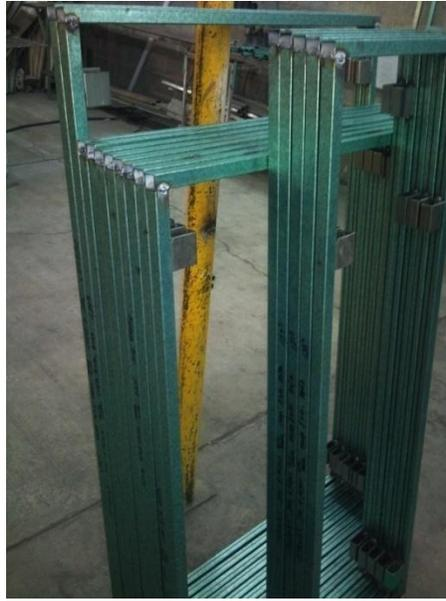
**IMAGEN 6.1 BASTIDORES DE TUBULAR SOLDADOS EN AREA DE HERRERÍA (CADA BASTIDOR DEBE LLEVAR SU NOMBRE DE LA PIEZA Y LA OBRA A LA QUE PERTENECE PARA EVITAR CONFUSIONES Y DETECTAR LAS PIEZAS MÁS RAPIDO)**
