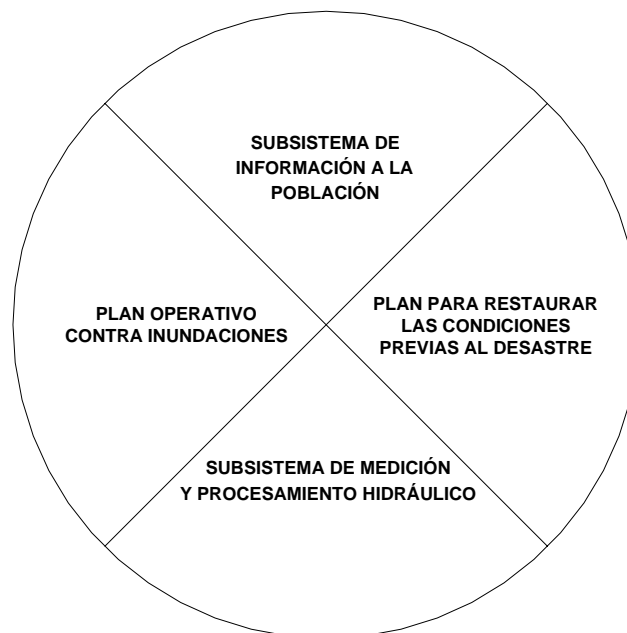
Figura 5.2 Componentes de un SAHTM (fuente: CENAPRED)
