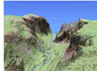
En la figura 9 se muestra el DEM de la DAO, se puede apreciar que da la apariencia de ser en 3 dimensión pero sin dejar de 2 dimensiones, a esto es lo que se le llama 2.5 dimensiones.
