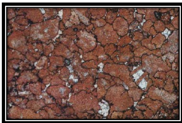
Fig. 2.34 Microfotografía de una caliza que muestra disolución por presión, al grado de desaparecer los bordes originales de los granos, roca del Carbonífero de Inglaterra (Mackenzie, 1997).
