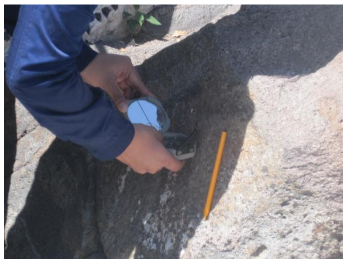
Figura 3.12 Medición de rumbos de fracturas en el sector norte del cerro del Tepeyac.
