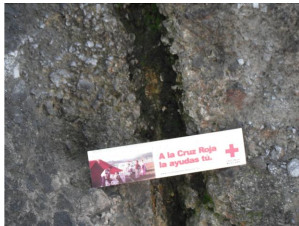
3.53 Fotografía de las fracturas observadas en el afloramiento sobre el Circuito Interior (Bicentenario) al Oeste del Peñón de los Baños.
