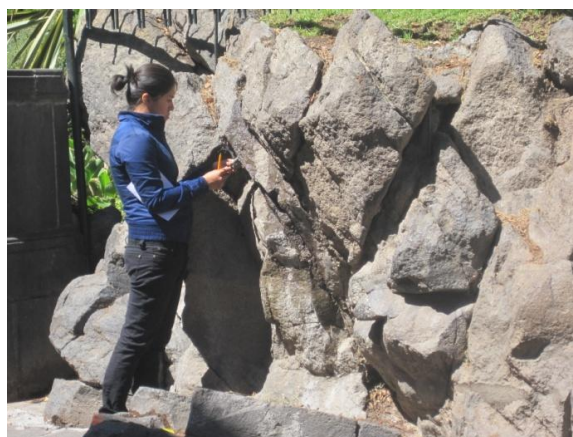
1.5 Medición de echados en roca.
