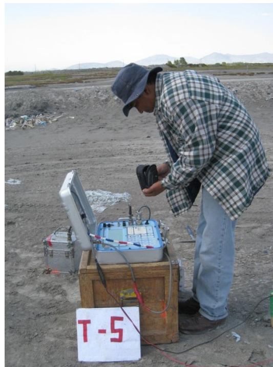
Figura 9. Aplicación de un tendido electromagnético TEM en el área de estudio.
