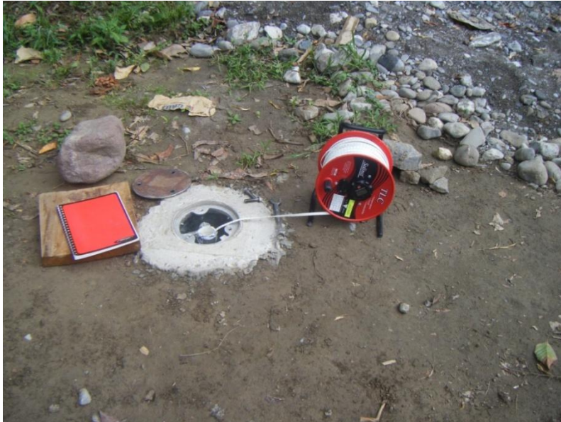
Foto 4.1. Se muestra como se toman las lecturas con la sonda tipo Solinst
