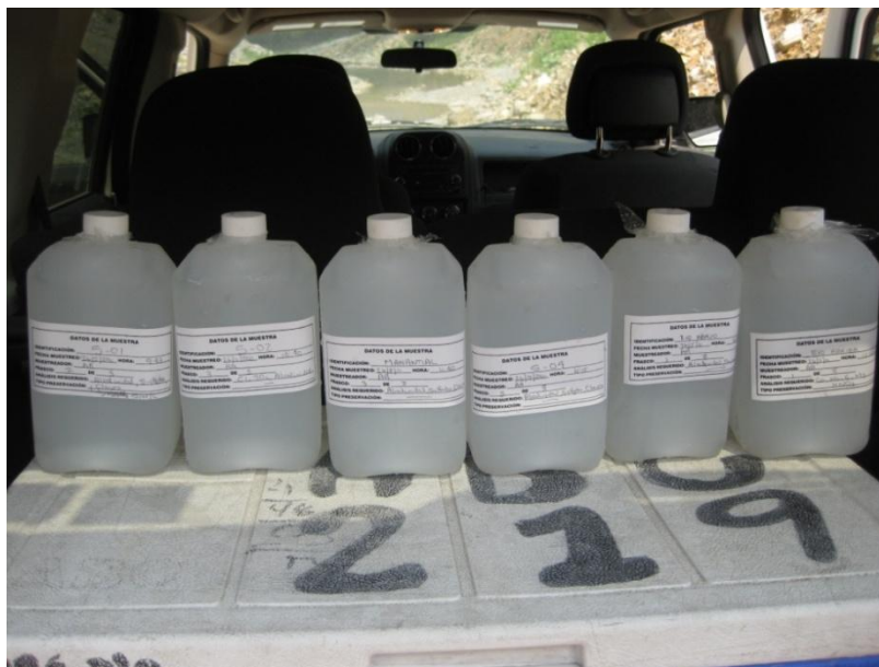
Foto 4.3. Envases de polipropileno de 1 litro después de haber tomado la muestra de agua subterránea en los sondeos
