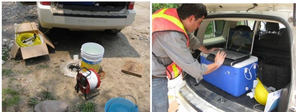
Foto 4.4 Izquierda, se aprecia el transductor marca Global Water, Foto 4.5 derecha adquisición de datos durante la prueba slug.
