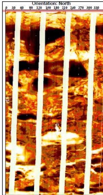
Figura 3.17 Ejemplo de porosidad vugular en una imagen eléctrica. Escala: 1/5 vertical y 1/5 horizontal. 41
