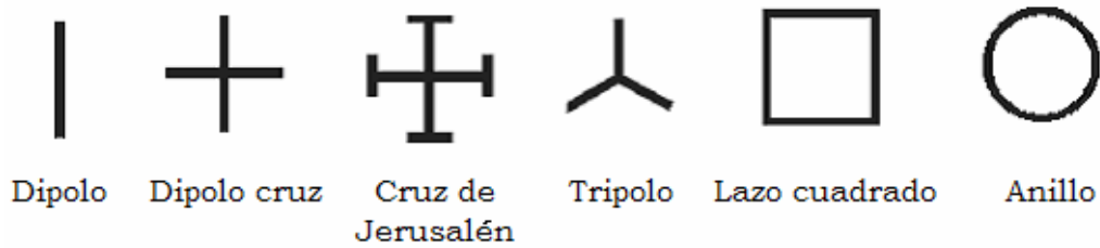
Fig. 1.3 Elementos en la SSF.
