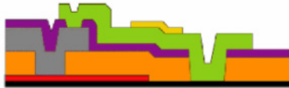
Fig. 2.5: Corte transversal de las 7 capas del proceso PolyMUMPs.
