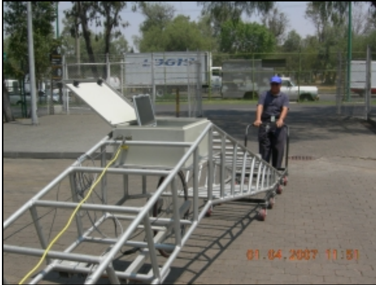
Figura 4.12. Pruebas de campo del perfilógrafo longitudinal en instalaciones de ASA.
