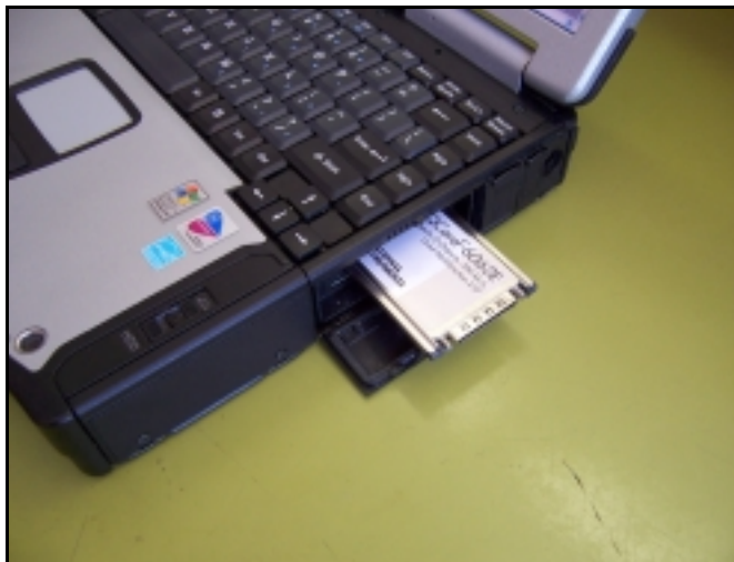
Figura 2.26. Inserción de la tarjeta de adquisición en la computadora.
