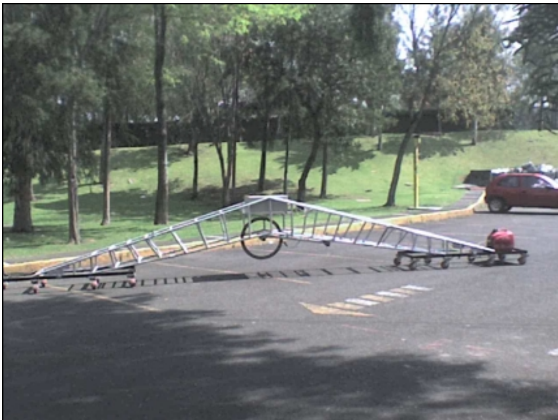
Figura 2.4. Fotografía de la estructura final del perfilógrafo.
