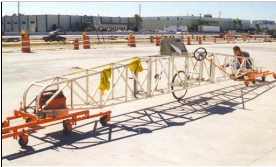
Figura 1.18. Perfilógrafo comercial modelo California.
