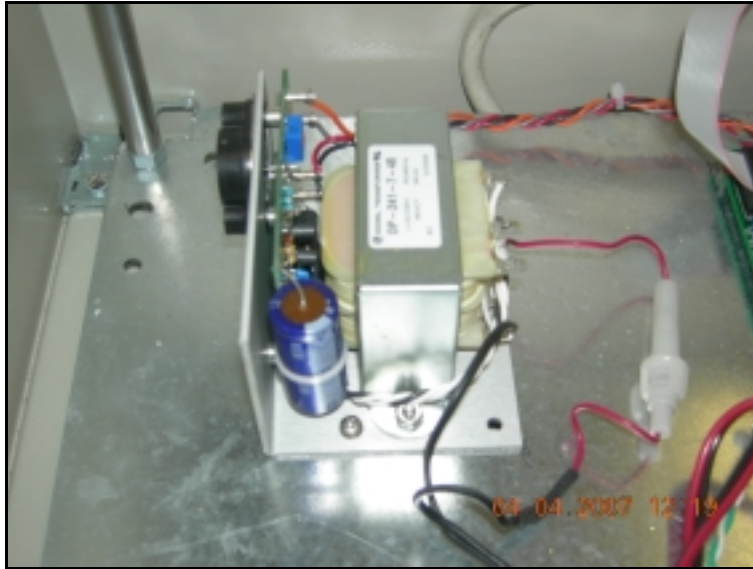
Figura 4.7. Montaje de la fuente de la impresora.
