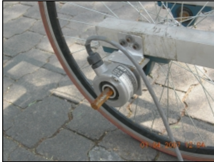
Figura 4.4. Montaje del sensor de desplazamiento horizontal.
