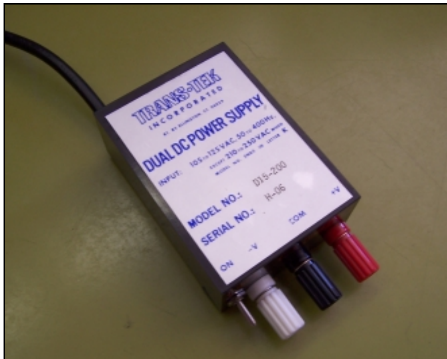
Figura 2.21. Fuente de alimentación del ADT.
