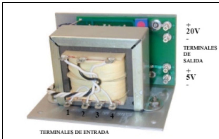
Figura 2.39. Terminales de la fuente de alimentación del módulo de impresión.
