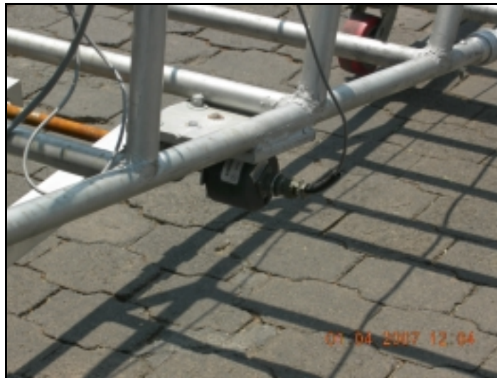
Figura 4.5. Montaje del sensor de desplazamiento vertical.
