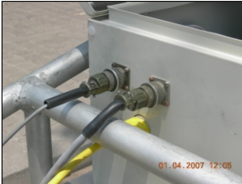
Figura 4.2. Conexiones de alimentación y de los transductores de desplazamiento.
