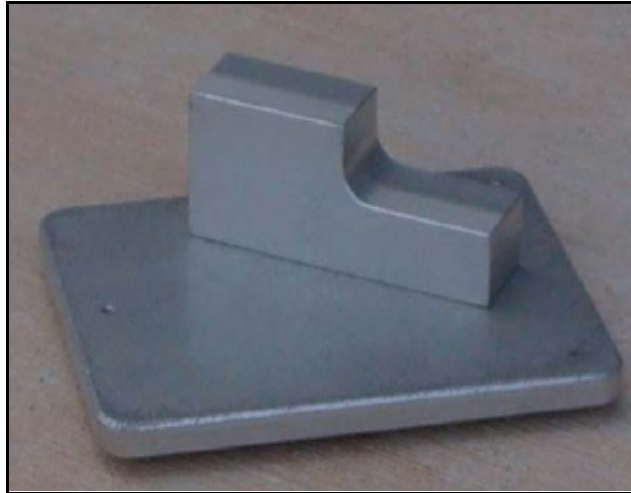
Figura 4.10. Bloque de calibración de la escala vertical.
