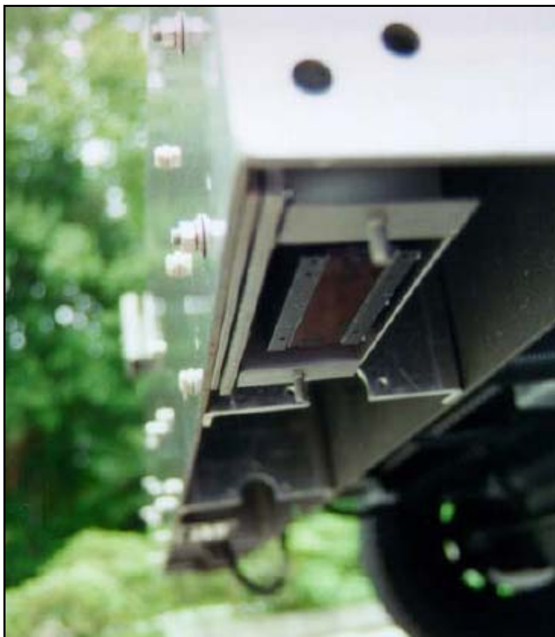
Figura 1.16. Detalle de la colocación del sensor láser en el perfilógrafo.
