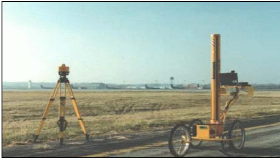
Figura 1.4. Equipo de varilla y nivel para la determinación del perfil.
