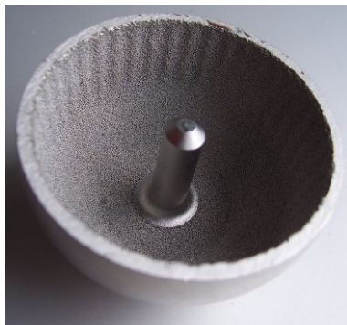
Fig.6.2 Estrías verticales en la superficie interior. Estas estrías cambian el área sobre la que se soporta la prótesis.
