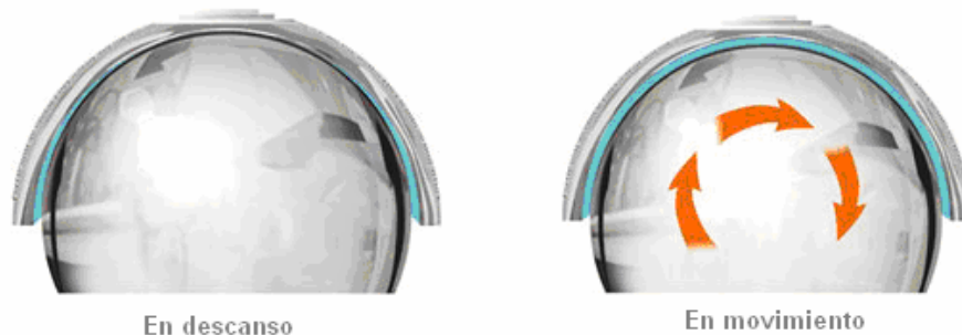
Fig. 2.2 Lubricación de una prótesis de superficie, metal sobre metal (Smith and Nephew).
