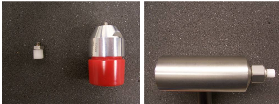
Fig. 3.2 Extremos de contacto de nylon y goma, y extensor (martillo de impulsos Kistler)
