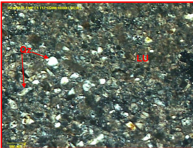
Fotomicrografía No. 5.- VCKSI. NP. Tramo No. 12. Corrida No. 1. 1230 m. Compuesta por laminaciones de lutita gris claro y de lutita limoarenosa, cuarzo (Qz) del tamaño de limo muy fino a grueso ( 3.9 \mu - 62.5 \mu ). Microscopio petrográfico, 10XNX. Análisis petrofísicos: porosidad \Phi=16.3\% , permeabilidad k Klinkenberg= 0.0305 \text{ md} , densidad de grano= 2.67 \text{ gm/cm}^3 .
