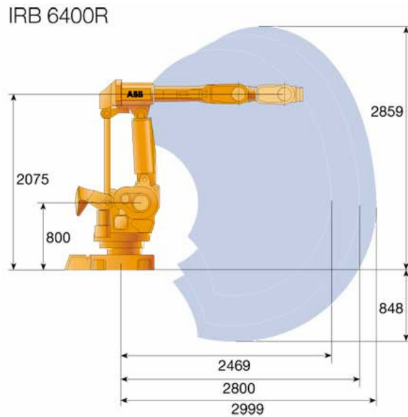
Figura 1.4 Área de trabajo de un robot de cadena abierta
