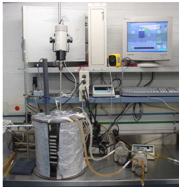
Figura 2.3 Fotografía del reactor anaerobio/aerobio
