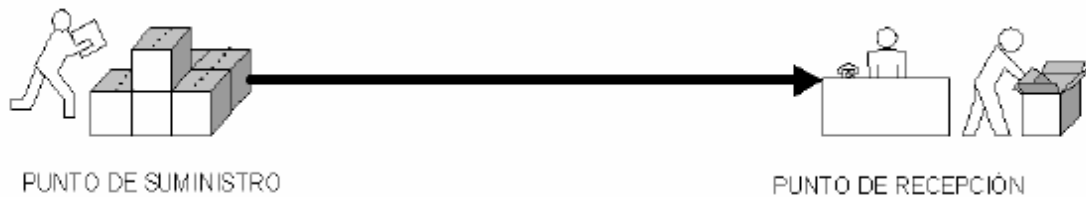
Figura.1. 2: Sistemas de distribución de paso simple
