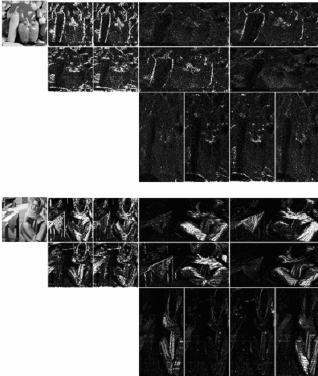
Figura 2.27. Ejemplos de la transformada contourlet de las imágenes “Peppers” y “Bárbara”. Para una visualización más clara, cada imagen está solamente descompuesta en dos niveles de la pirámide, a su vez descompuestos en 4 y 8 capas direccionales. Pequeños valores de coeficientes son mostrados en negro mientras que grandes valores son mostrados en blanco.
