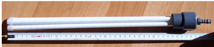
Figura 2.2. Módulo de membranas (MEMOS®, Alemania)
