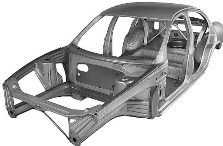
FIGURA 1.10 ESTRUCTURA DE ACERO ULTRALIGERO (ULSAB) [9]
