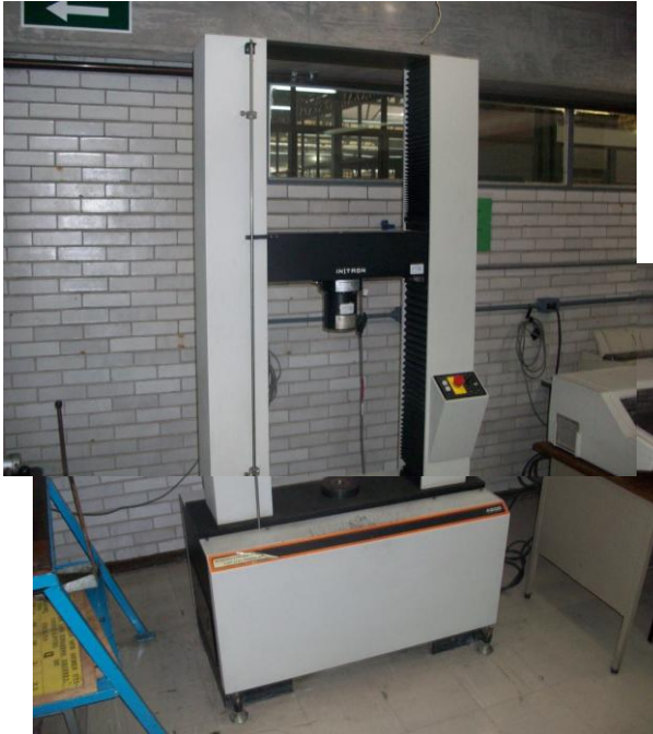
Figura 3.5 maquina instron Tx200 utilizada para los ensayos de tracción, y la celda de carga de 5kN.
