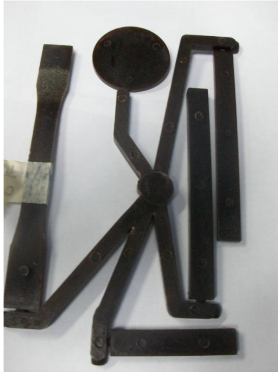
Figura 3.2 Probetas inyectadas ASTM 638 de polipropileno al 15% de fibra de nopal.
