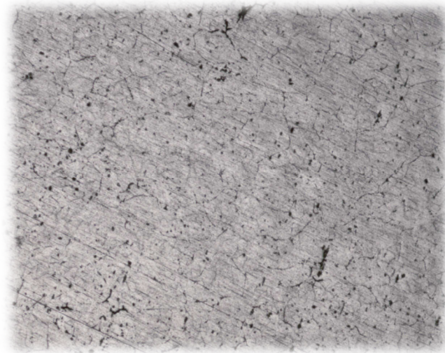
Figura 94. Metalografía de una sección del lingote del cual se obtuvo el material para las pruebas de validación del prototipo (Microscopio Nikon Epiphot 200, 100 aumentos).
