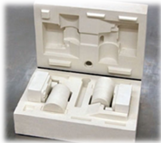
Figura 9. Molde de yeso para fundición.
