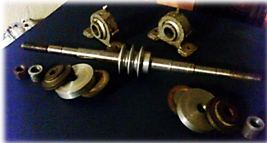
Figura 81. Eje de transmisión con sus componentes y las poleas de transmisión.
