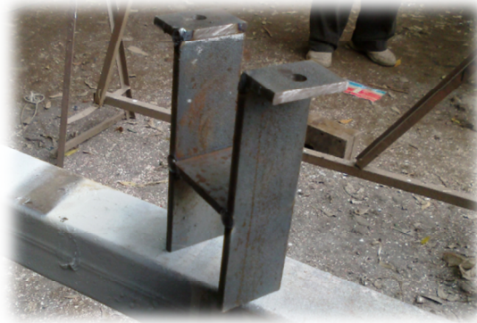
Figura 83. Base del sistema de vaciado.
