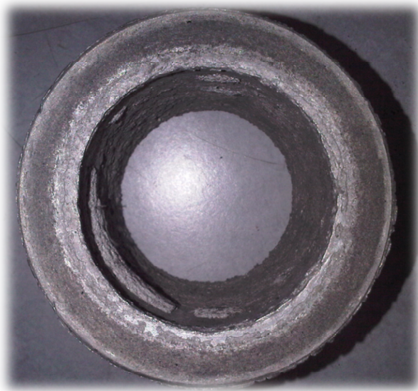
Figura 91. Esgurrimiento en la superficie interior del molde.
