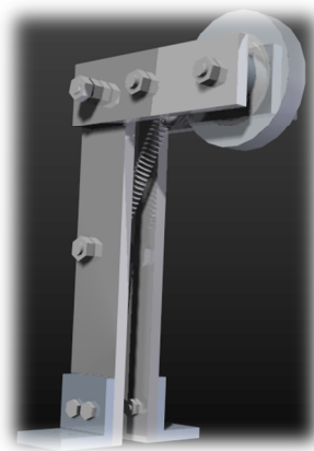
Figura 64. Ejemplificación del ensamble de la polea superior con su base y el resorte tensor.
