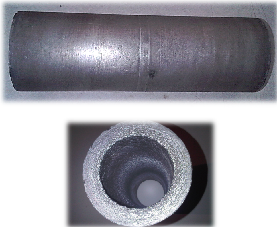
Figura 92. Pieza terminada de un proceso en el cual no se protegió el molde contra el desgaste por efecto de la difusión.
