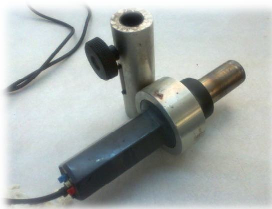
Figura 71. Pistola de aire caliente que se empleará para la etapa de precalentamiento.
