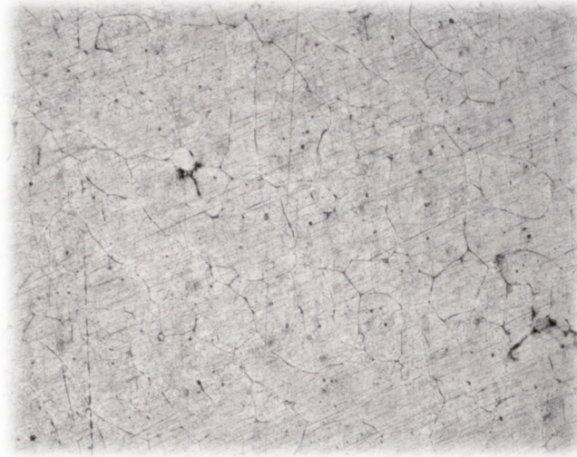
Figura 93. Metalografía de una sección del tubo obtenido por medio de fundición centrífuga (Microscopio Nikon Epiphot 200, 100 aumentos).
