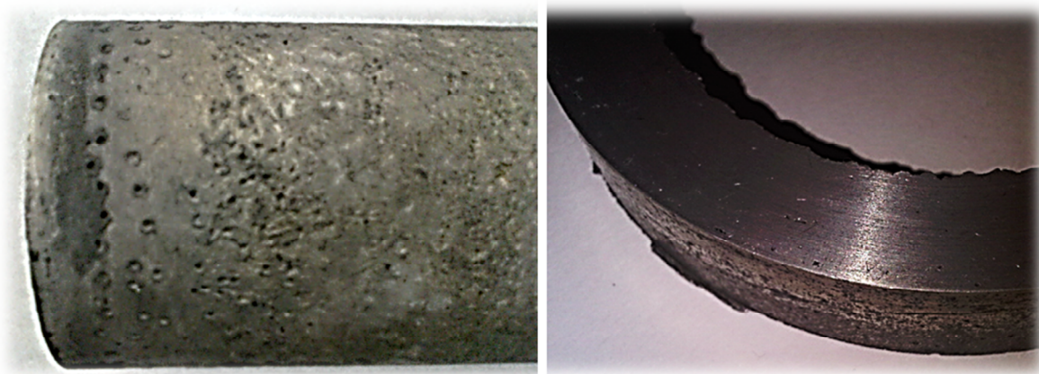
Figura 89. Defectos de porosidades durante el proceso usando pintura de grafito.
