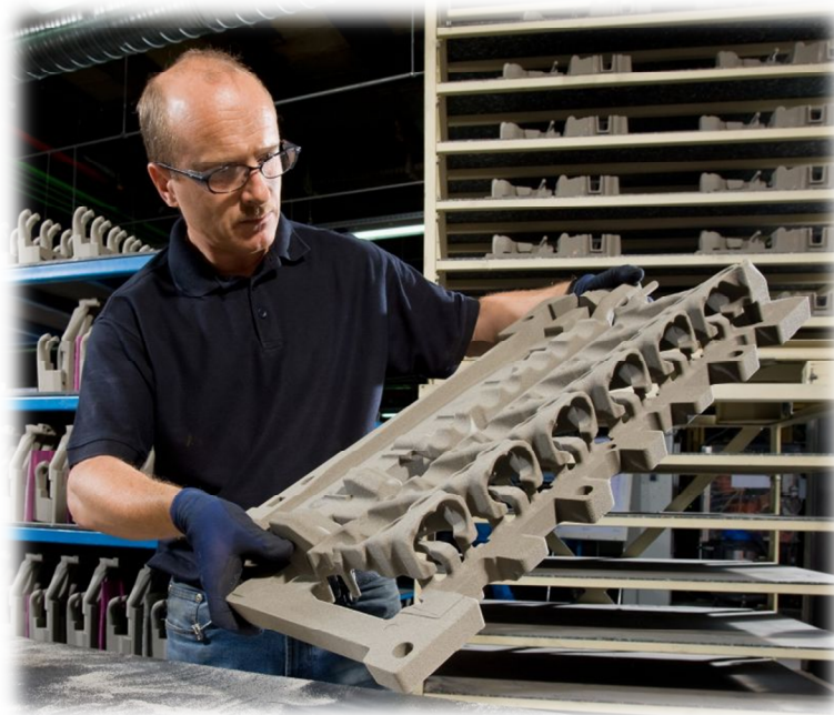
Figura 6. Corazón empleado en el proceso de fundición de bloques de motor de BMW.
