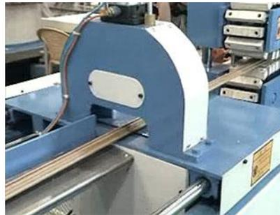
Figura 2.14 Cortador tipo guillotina
