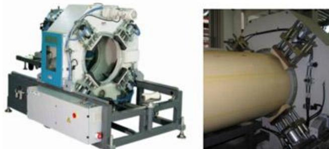
Figura 2.15 Cortador tipo cuchillas periféricas
