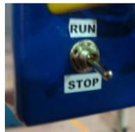
Fig. 5.3. Interruptor (run – stop) del variador de frecuencia
