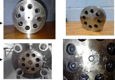
**Tabla 4.2** Flujo volumétrico en función de la geometría de salida del dado. Dependiendo del dado a utilizar se obtendrá diferente gasto, debido a las restricciones que genera el diseño del mismo [6]
