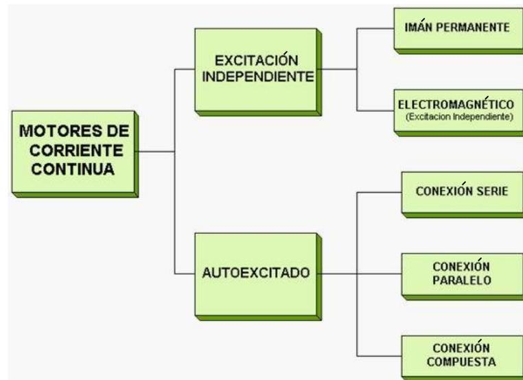
Figura 3.6 Clasificación de los motores de corriente directa
