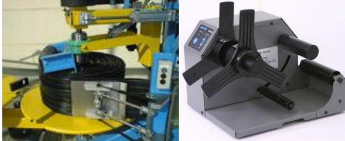
Figura 2.16 embobinador de perfiles flexibles y cortador para tubería rígida
