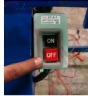
Fig. 5.1. Botón de encendido – apagado general del carro
