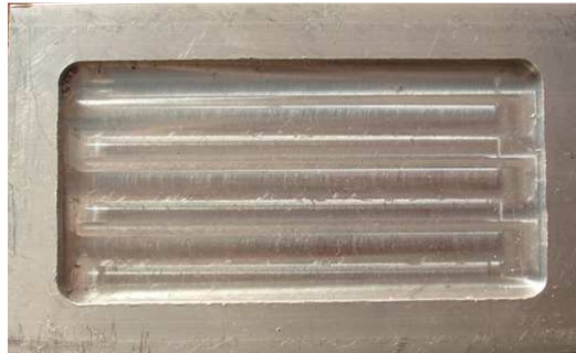
Figura 3.20 Cavity maquinada con estrategia zigzag
