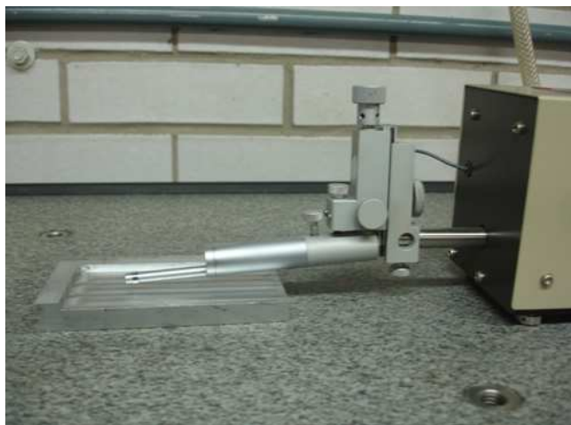
Figura 3.27 Medida de rugosidad superficial
