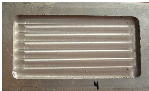
Figura 3.22 Cavity maquinada con estrategia un sentido
