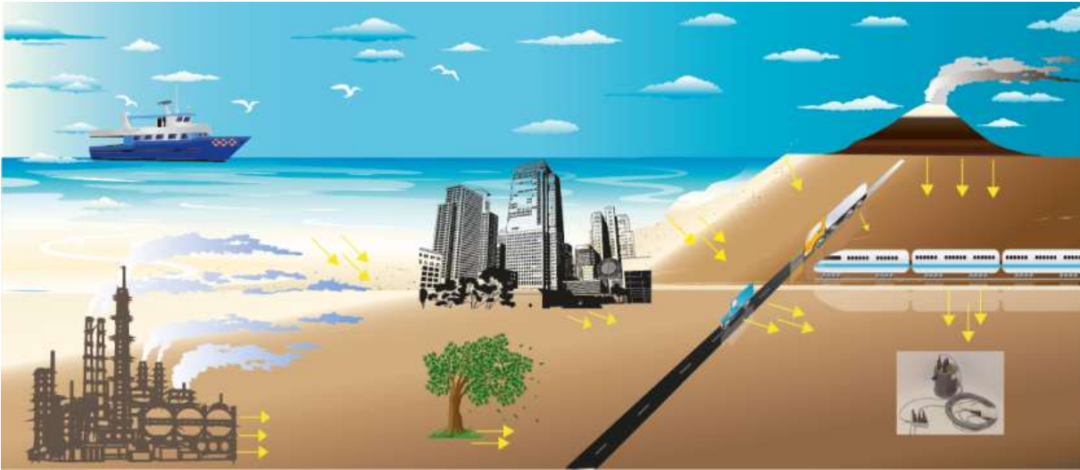
Figura 1.1. Diagrama de algunos ejemplos de fuentes generadoras (natural y artificial) de Microtremores. Yauri , 2006 (Modificada)
