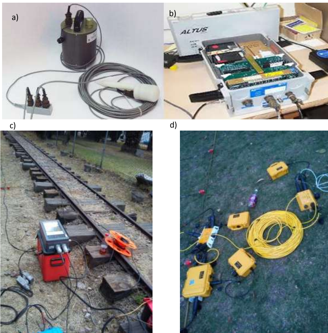
Figura 2.3. Instrumentos de registro de banda ancha. a) Guralp Systems modelo 6TD. b) acelerómetros K2 de Kinematics. c) Geometrics modelo Strataview de 24 canales. d) Seistronix modelo EX-12 de 72 canales
