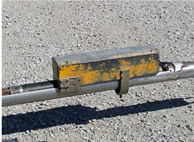
Figura3.21. Colocación del Jig.
