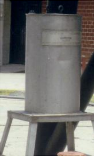
Figura 3.9. Tanque de calibración de las herramientas de Neutrón (patrón secundario).
