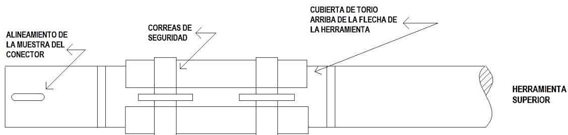
Figura 3.4. Representación de las partes de la herramienta de Espectroscopía de Rayos Gamma.
