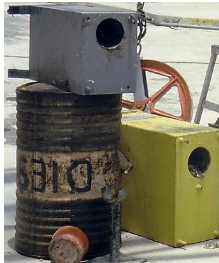
Figura 3.18. Patrón secundario de medición en la calibración de las herramientas de Densidad.
