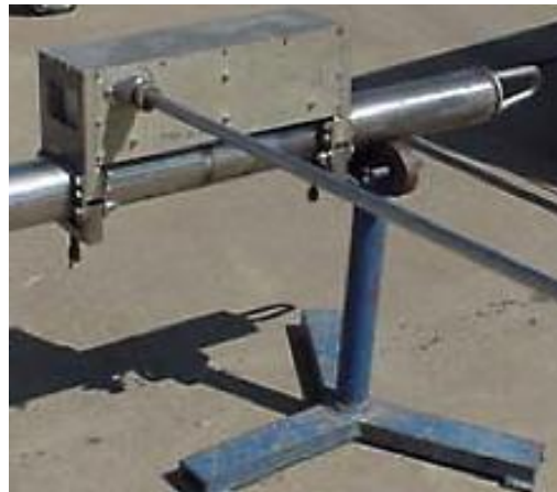
Figura 3.12. Calibración de la herramienta con el bloque verificador de 38.7 cm.
