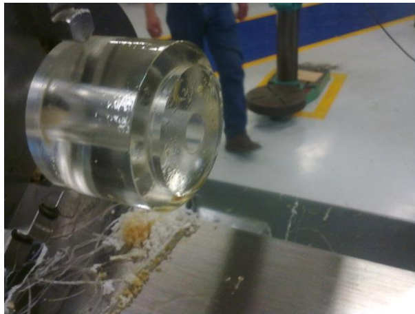
Figura 40. Maquinado de acoplamiento.
