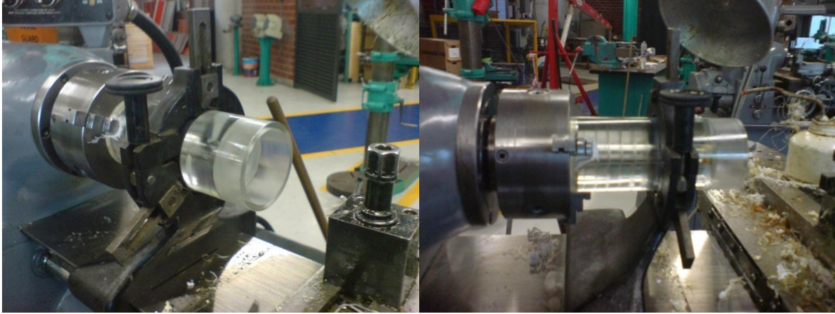
Figura 39. Manufactura de la zona de conexión con la tubería previa y posterior al tubo Venturi.
