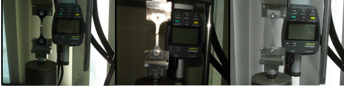
Figura 2. 14 Estado de las probetas al finalizar la prueba de tensión.
