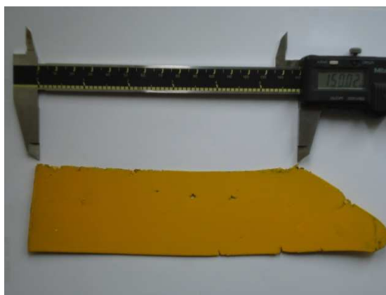
Figura 2. 7 Muestra conformada por laminación de la AZ31 0.1 Pr y preparada para elaboración de probetas.
