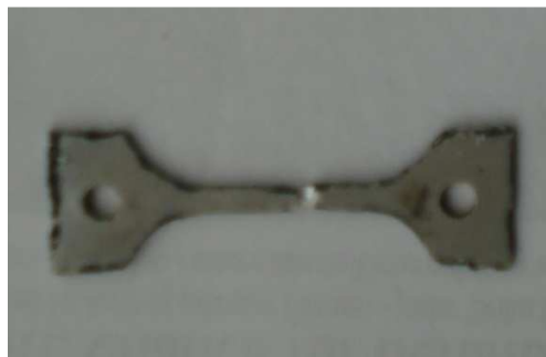
Figura 3. 25 Probeta dañada por tratamiento de 10000 segundos, aleación AZ31.
