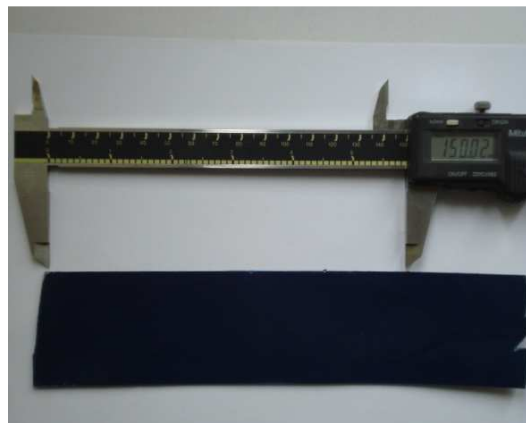
Figura 2. 8 Muestra de AZ31 0.3Pr, posterior al proceso de laminación y preparada para fabricación de probetas.
