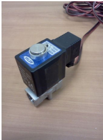
Figura 21. Electroválvula modelo 2S050-15.
