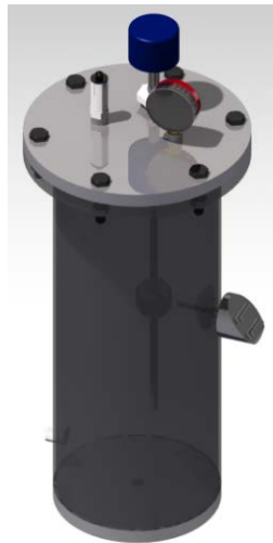
Figura 16. Modelo y renderizado del tanque de mediciones. Modelo hecho en Catia V5R19.
