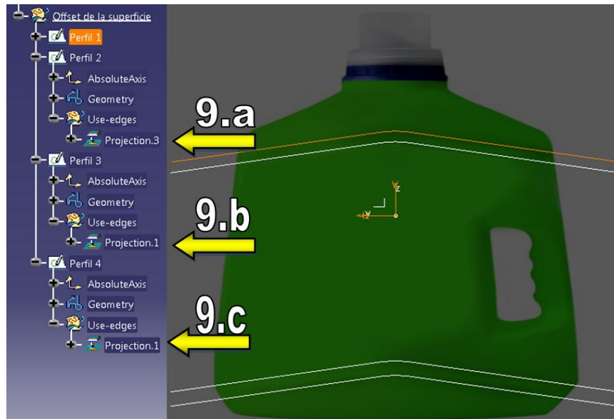
Fig. 3.1.14 Repetición de perfiles dentro de diferentes Sketches . (9.a, 9.b, 9.c) Proyecciones del primer perfil como elementos de construcción.
