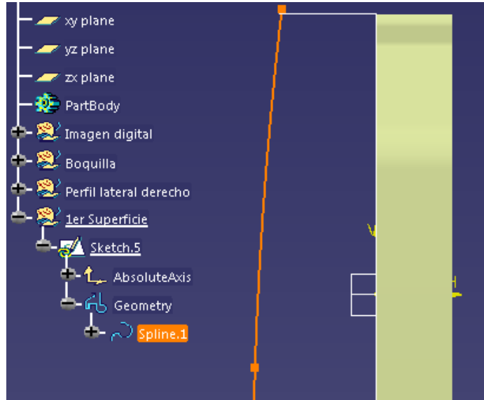
Fig. 3.1.6 De forma inicial, no es necesario imponer restricciones en esta geometría, debido a que aún faltan operaciones por agregar.
