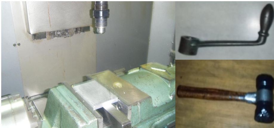
Fig. 3.5.2 Montaje del tocho
