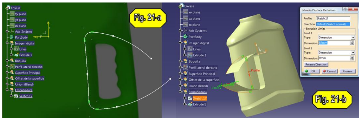
Fig. 3.1.21 Generación de perfiles para la empuñadura
