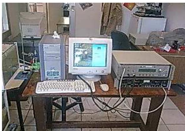
Figura 3.15 Potencioestado RADIOMETER COPENHAGEN VOLTALAB PGP201
