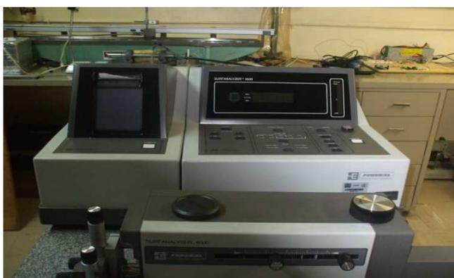
Figura 4.10 Rugosímetro FEDERAL SURFALYZER 4000
