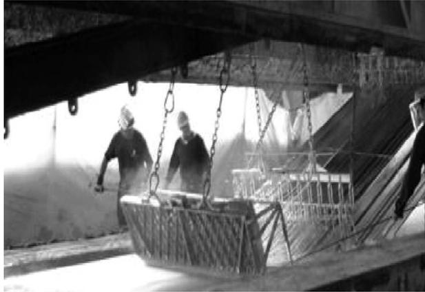
Figura 1.3. Proceso de galvanizado en caliente para grandes perfiles estructurales [3]
