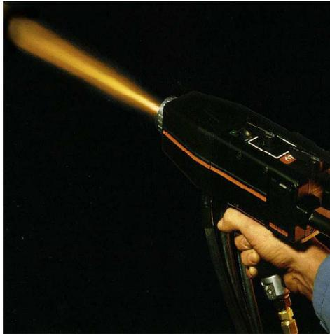
Figura 2.33 Pistola de proyección térmica por arco eléctrico [10].
