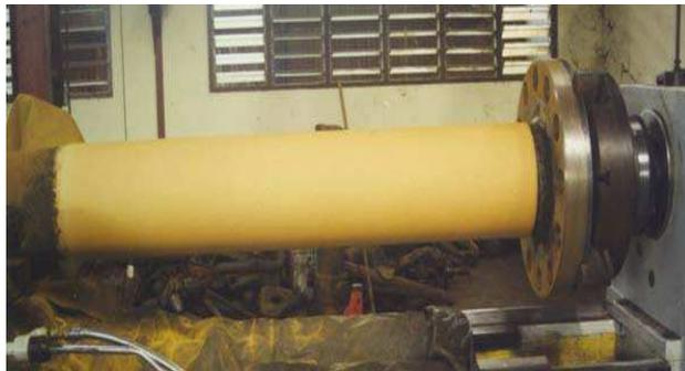
Figura 2.21 Recubrimiento de aluminio-bronce obtenido después de rociar [10].
