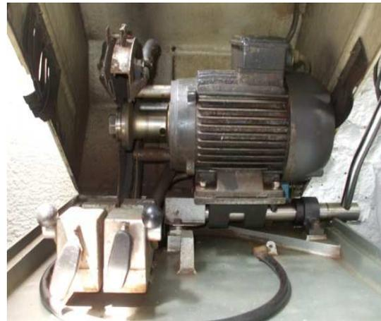
Figura 3.7 Interior de la cortadora metalografía ABRASIMET 2
