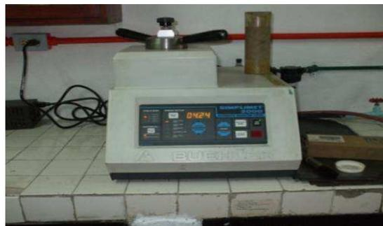
Figura 3.8 Montadora BUEHLER SIMPLIMENT 2000.
