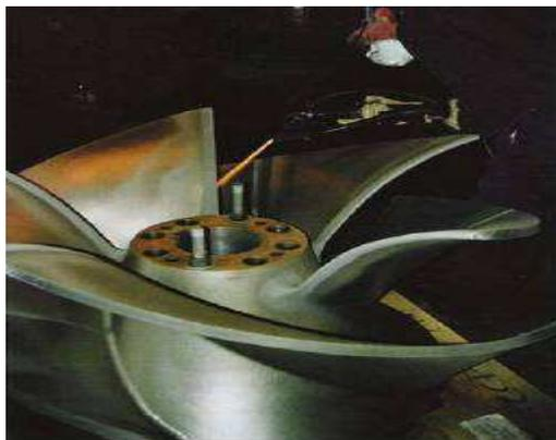
Figura 2.14 Propela de Barco recubierta con equipo HVOF [10].
