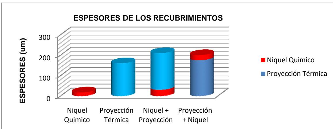
FIGURA 4.9 Espesores de los diferentes recubrimientos realizados.
