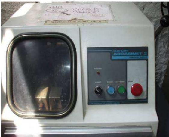
Figura 3.6 Cortadora metalografía ABRASIMET 2
