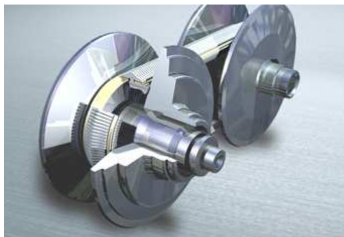
Figura I-4: Configuración básica de una transmisión CVT [H-2]
