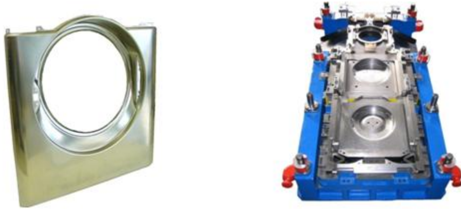
Figura 1.2 Ejemplo de pieza troquelada y troquel progresivo. [3]
