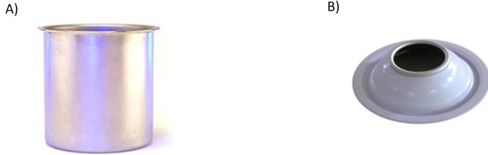
Figura 3.2. A) Embutido cilíndrico profundo sin escalones. B) Embutido escalonado.
