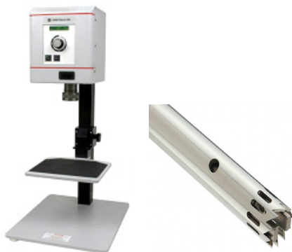
Figura 2.1 Homogeneizador “Macro Omni Es” y tipo de agitador que se utilizó para la preparación de la emulsión.
