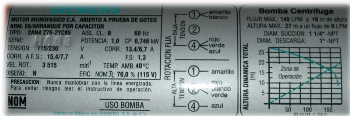
Figura 46.- Grafica Q-H del distribuidor
