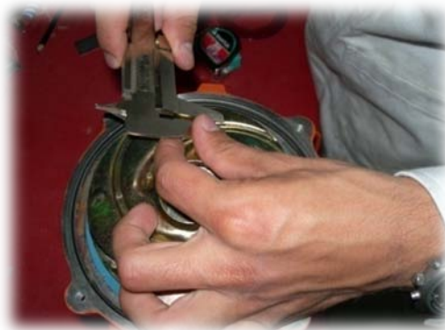
Figura 49.- Medición con calibre Vernier
