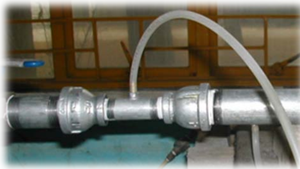
Figura 54.- Tubo Venturi utilizado en las pruebas de laboratorio
