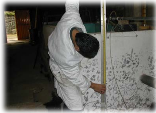
Figura 57.- Tomando mediciones en el Manómetro Diferencial de Hg
