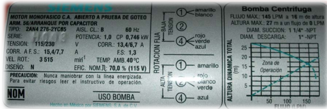
Figura 67.- Grafica Q-H del distribuidor
