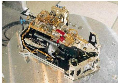
Figura 3.1.6 Interferómetro del MIPAS del ENVISAT [3]
