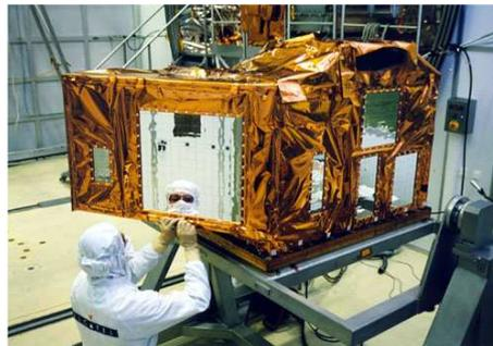
Figura 3.1.9 MERIS armado del ENVISAT [3]
